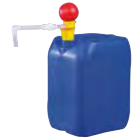
OTAL-Handpumpe, PP Kompakte und platzsparende Handpumpe mit guter Förderleistung. Der Universal-Stop- fen besteht aus Weich-PVC, geeignet für Be- hälteröffnungen von 30-70 mm Ø. 14 Liter/ min., 12 mm Rohr.
