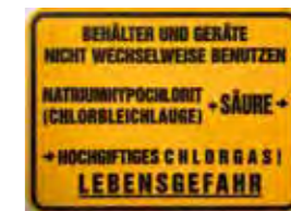
"Natriumhypochlorit" Deutliches Hinweisschild "Natriumhypochlorit" in gelb! Durch die intensiven Farben ist das Zeichen deutlich erkennbar.
